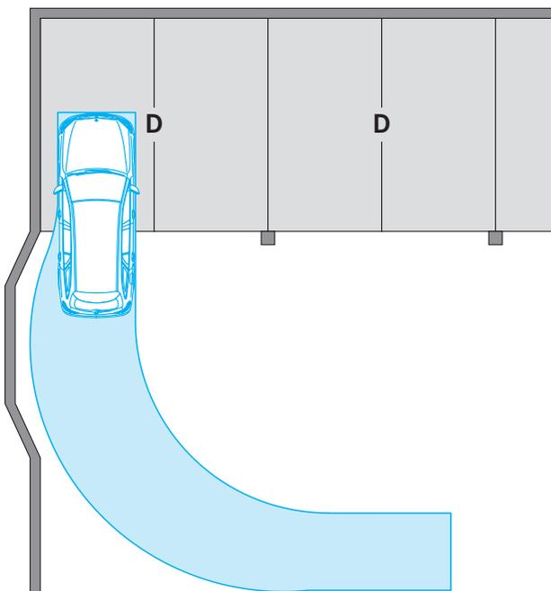
Pour les places de parking à la fin de la ligne de jalonage à un angle de 90°, la largeur d'entrée doit être d'au moins 275 cm. Nous recommandons à la fin de la ligne de jalonage, si cela est techniquement possible, de prévoir un renflement de la paroi.
