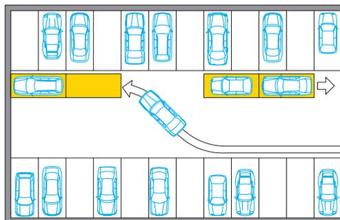
Les places de stationnement sur les plates-formes sont directement accessibles ou sont déplacées jusqu'à ce qu'il y ait suffisamment de place pour manœuvrer et se garer.
