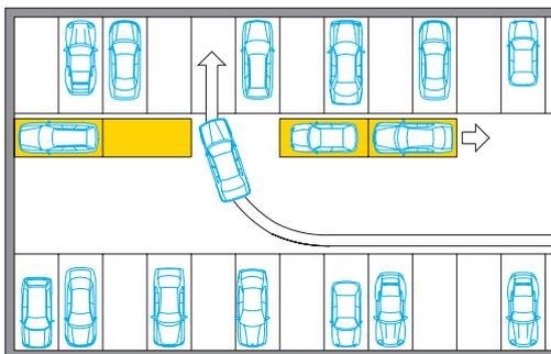
Les plates-formes occupées sont déplacées par pression sur un bouton jusqu'à ce que les places de stationnement situées derrière ou en face soient accessibles. Les plates-formes inoccupées peuvent être traversées.
