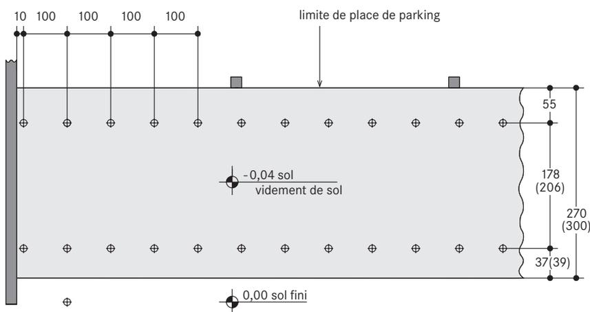
⊕ Points de mesure distants de 100 cm sur la longueur, destinés à vérifier les défauts de planéité selon la norme DIN 18202, tableau 3, ligne 2 ou selon le diagramme
