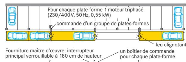
Les plates-formes peuvent être déplacées vers d'autres blocs de plates-formes si l'emplacement du boîtier de commande est à moins de 10 m des bords de plate-forme devant rejoindre un bloc.
